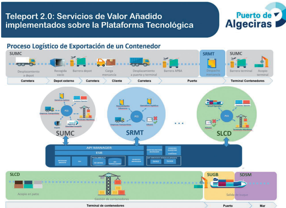
Figura 9. Teleport 2.0 - Implementación de Servicios de Valor Añadido o Módulos de Negocio intercambiando información entre ellos a través de la infraestructura tecnológica del PCS.
