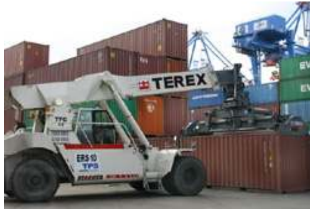
Figura 27. Reachstaker en la Terminal Pacífico Sur.
