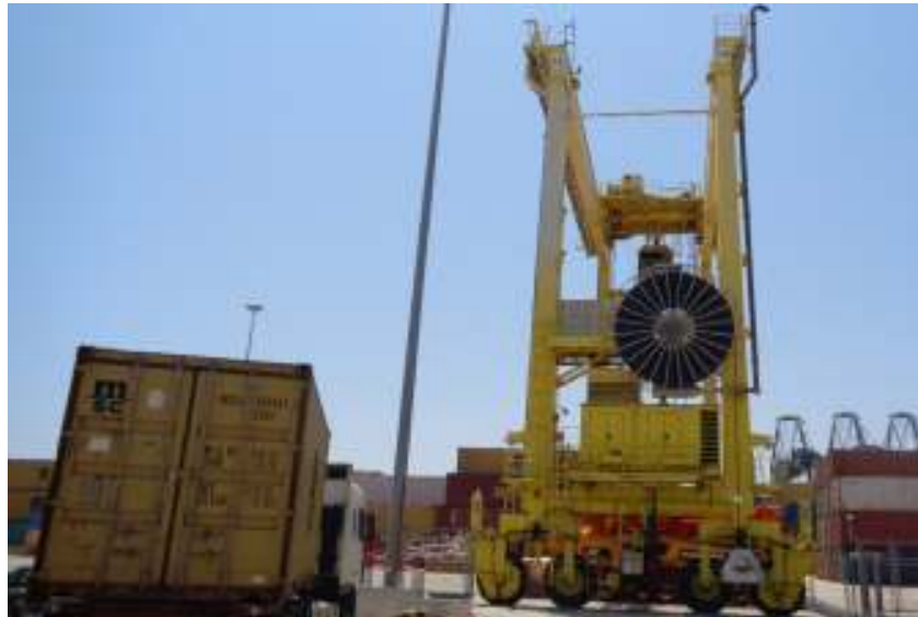
Figura 17. Grúa Electrificada en MSC Terminal Valencia con el Sistema Cable Reel
